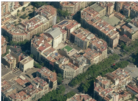
Imatge 1: Illa pilot de MARIE a l'eixample de Barcelona. La superfície lliure de coberta per producció d'electricitat solar és del 32% prop de 3.200 m 2
